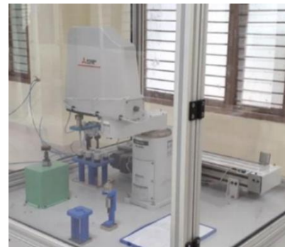
(ii) Robot Cell (Mitsubishi 4-axis, SCARA)
